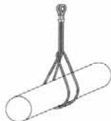
Rys. 3 Zawieszanie z obwiązaniem pętlą przesuwaną podwójnie
